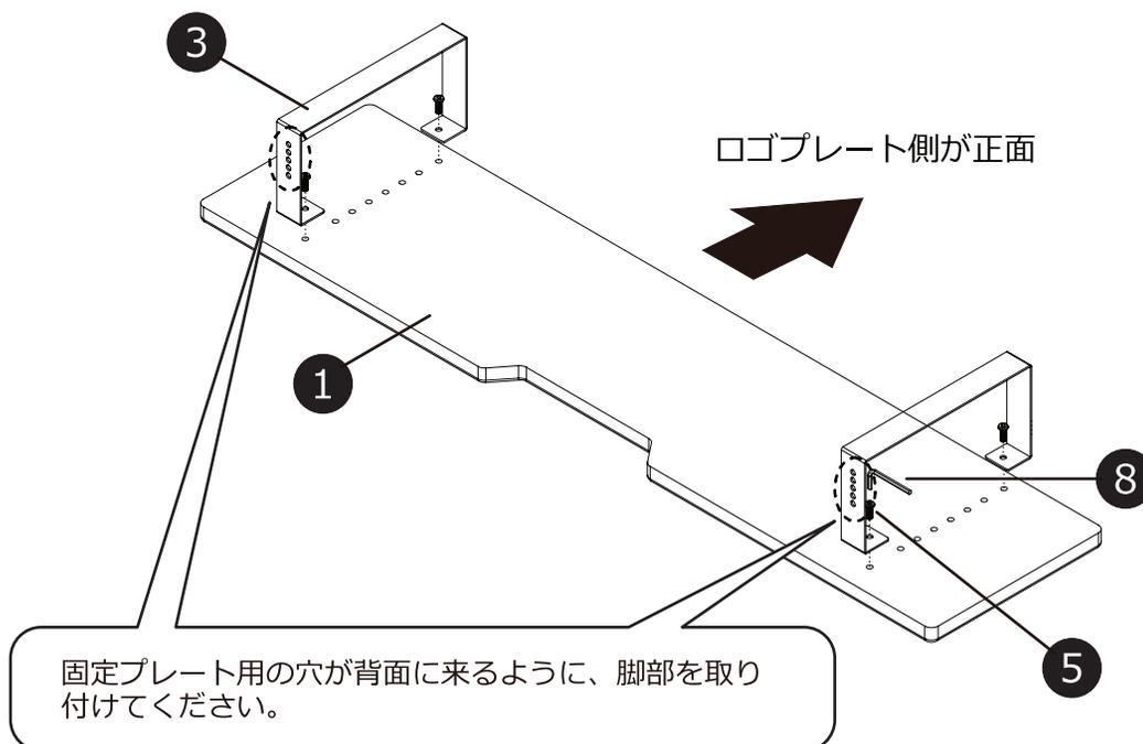
2 設置する場所に仮置きして、②幕板の取り付け位置を決めます。
