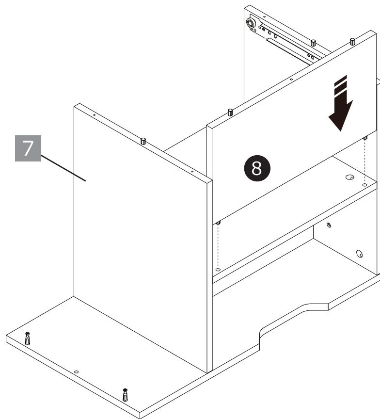
9 8で組み立てた棚板に③側板（左）を取り付けます。
