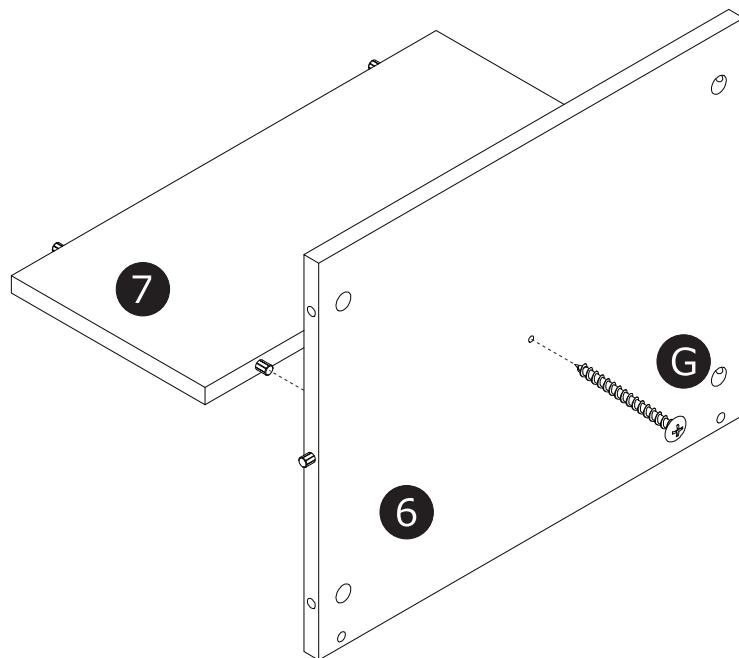
5 ④で組み立てた棚板に④側板（中）と⑤側板（右）を取り付けます。
