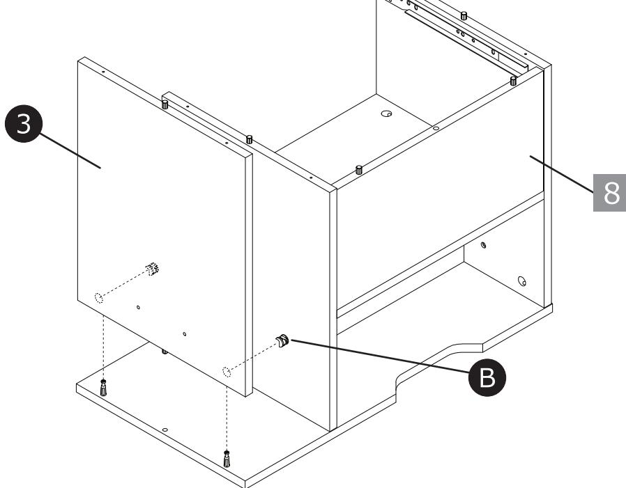
10 9で組み立てた棚板に②底板を取り付けます。
