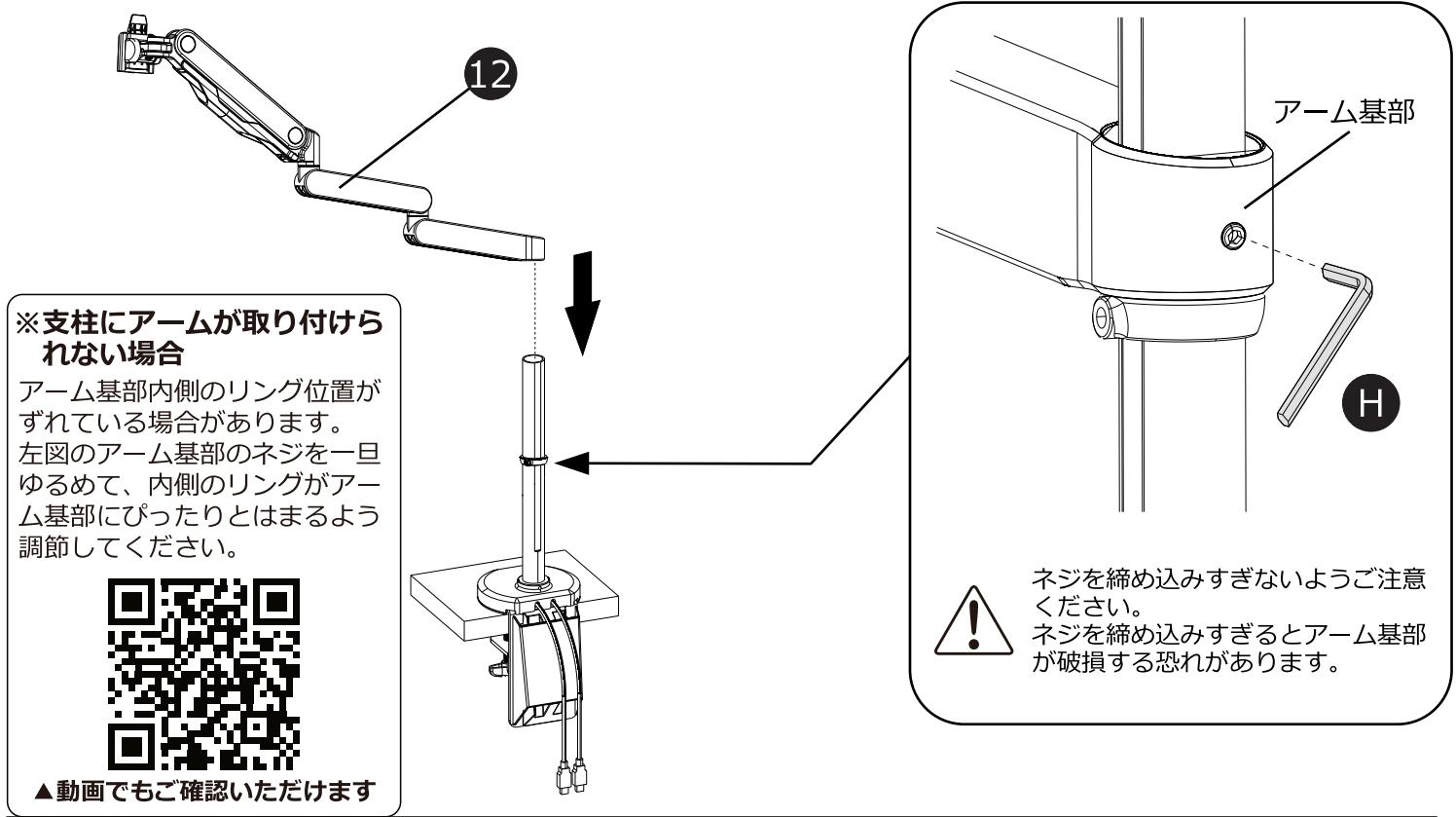
10 同様に⑭補助リングと⑬ミドルアームを取り付けてから、⑮支柱用キャップを取り付けて完成です。
