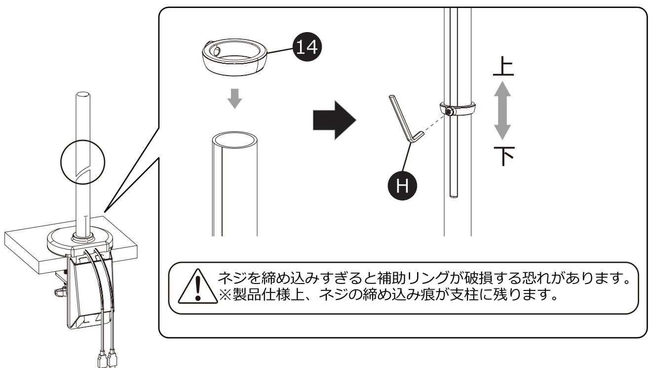
9 ⑧で取り付けた補助リングの上から⑫ロングアームを取り付け、アーム基部が支柱上で回転しない程度にネジを締めて固定します。
