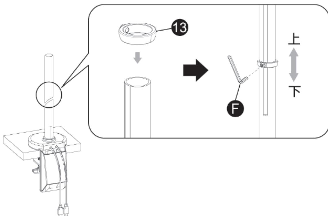
9 ⑧で取り付けた補助リングの上から⑫ロングアームを取り付け、ボルトをしっかりと締めて固定します。
