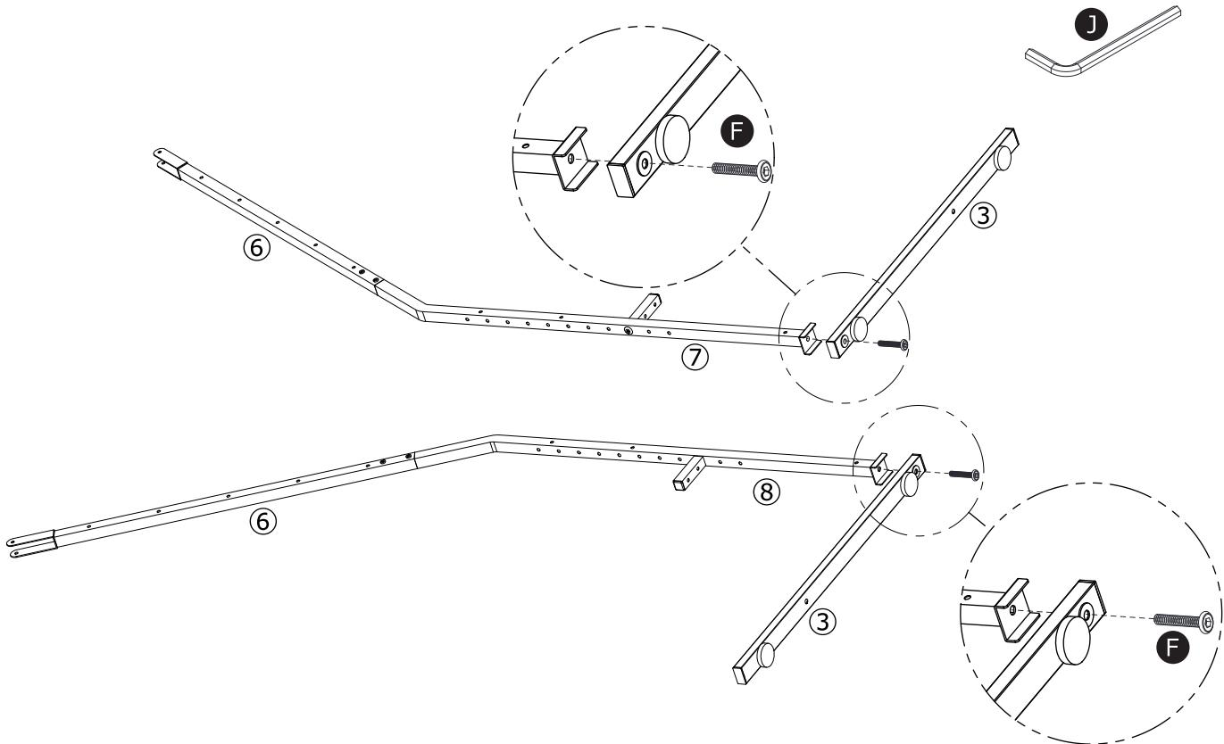
6 ③で組み立てたフレーム前をFのボルトを使用して取り付けます。
