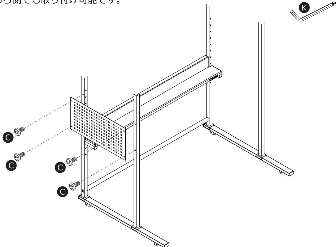
10 必ず転倒防止用プレートを取り付け、ベッドの脚部をプレートの上に載せて製品を固定してください。
