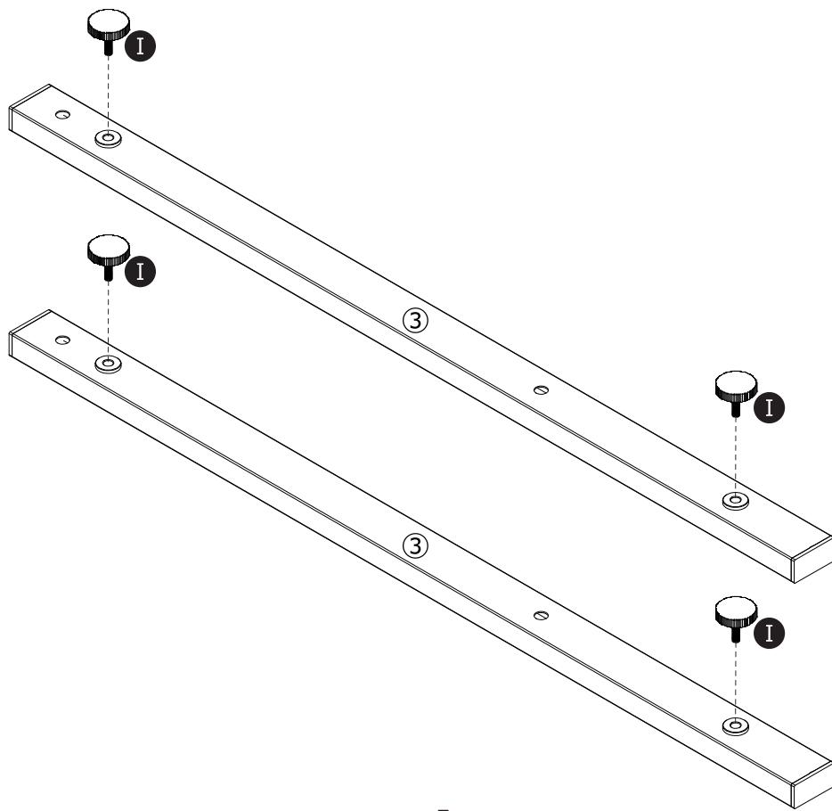
3 フレーム前\_上部とフレーム前\_下部をCのボルトで取り付けます。
