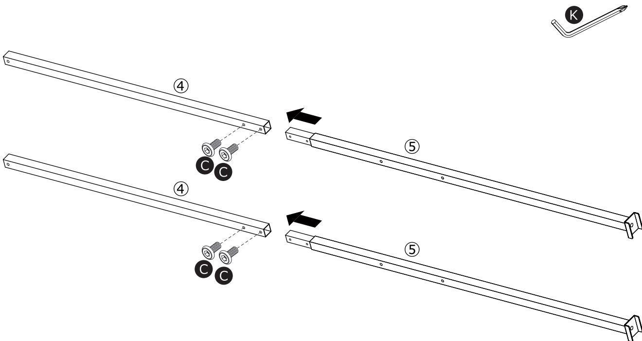
4 フレーム後\_上部とフレーム後\_下部をCのボルトで取り付けます。
