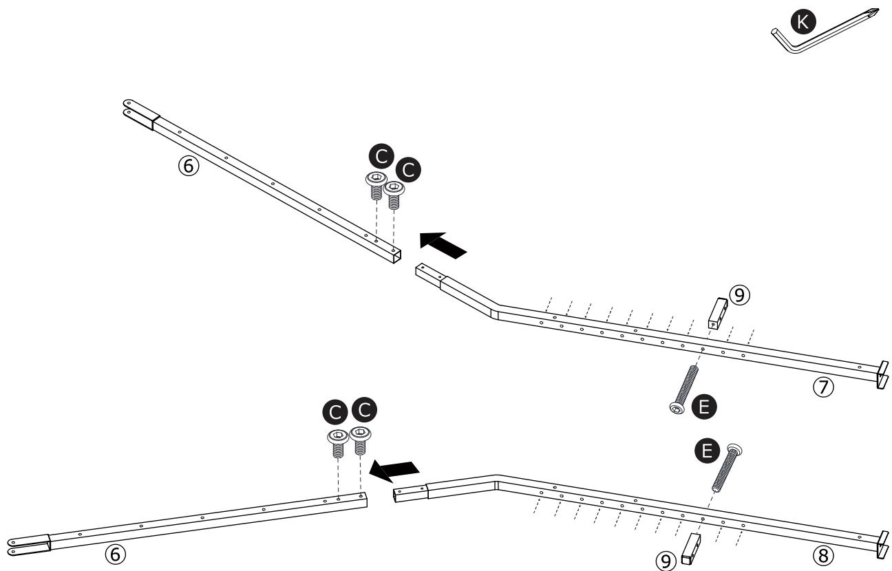
5 ②④で組み立てたフレーム後と脚部底部をFのボルトを使用して取り付けます。
