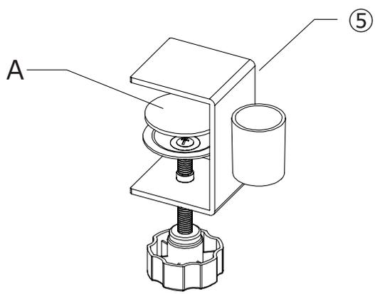
2 支柱を組み立てます。その後テーパースリーブの細い部分を下側にして、お好みの位置にクランプを取り付けます。
