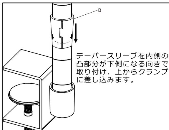
3 お好みの位置にテーパースリーブを取り付け、カゴ・フックを取り付けます。その後、残りのパーツも同様の手順で取り付けます。
