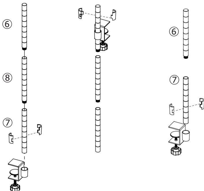
クランプ部分への支柱とテーパースリーブの取り付け方
