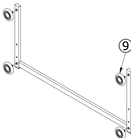
③ ②で組み立てた脚部底部に、①脚部（右）と②脚部（左）を取り付けます。
