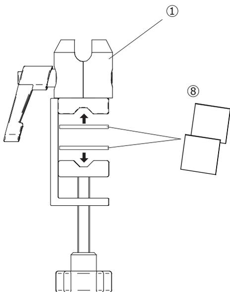
② 取り付けたい天板や棚板を①クランプ部の固定部分で挟み込みます。位置を決定したらノブボルトを回し固定します。
