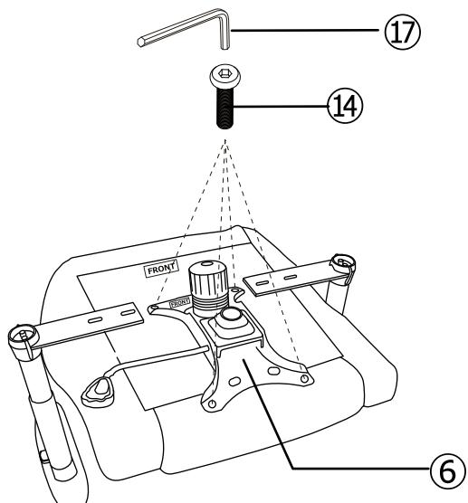
**⑦** ③～⑥で組み立てた椅子上部を、①～②で組み立てた脚部に取り付けます。
