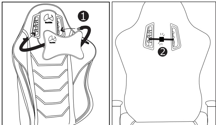
ヘッドラストはヘッドラスト穴についている突起に引っ掛けることで、4段階の高さ調節が可能です。
