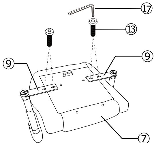
**⑥** ⑤でアームレストを取り付けたシート部分に⑥座受金属部を取り付けます。
