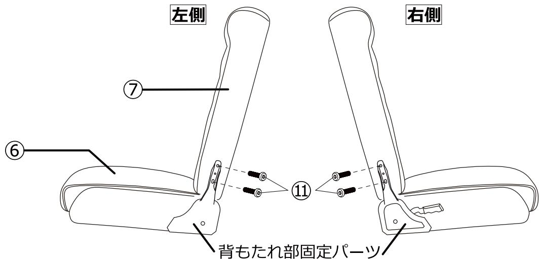
**④** ③で組み立てたシート部分の背もたれ部固定パーツに⑨⑩のカバーを取り付けます。付属のボルトは小さいので、なくさないようにご注意ください。
