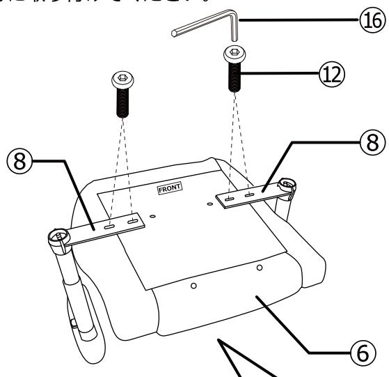
**⑥** ⑤でアームレストを取り付けたシート部分に⑤の座受金属部を取り付けます。
