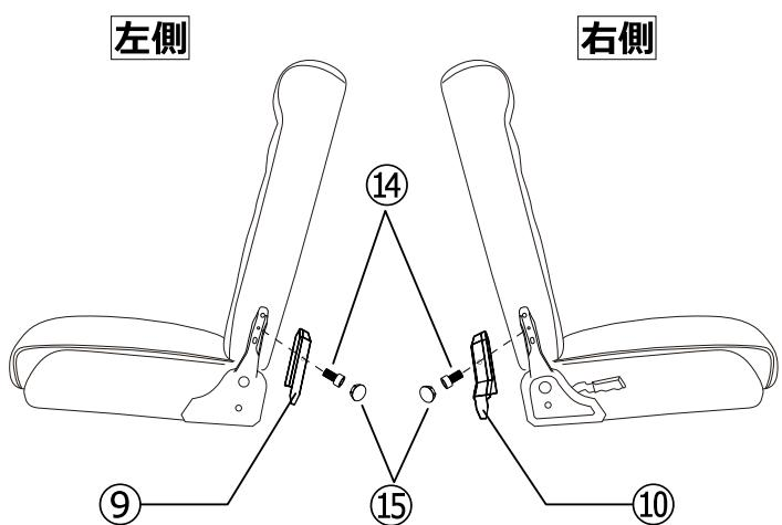
**⑤** ⑤でアームレストを取り付けたシート部分に⑤の座受金属部を取り付けます。
