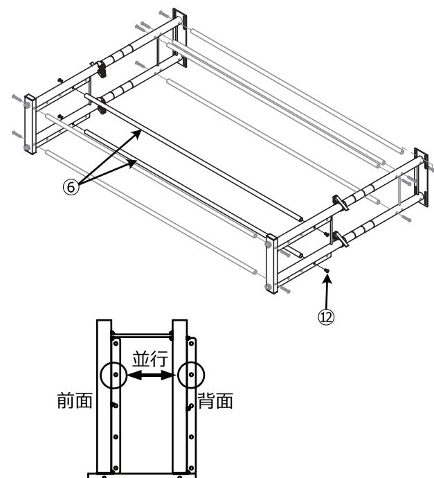
(6) ⑫のボルトで⑥ポールを(5)の工程でポール取り付けた場所以外の位置に取り付けてください。
