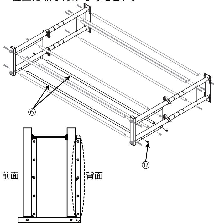
(7) (5)で組んだ脚部に、(1)の天板を⑫のボルトで脚部に取り付けます。天板のボルトが全てまっすぐ入ったことを確認後、(2)～(5)で仮組みしていたボルトを六角レンチでしっかりと締めます。その後製品をひっくり返してください。
