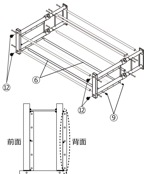
(4) ⑨ボルトで⑥中段用ポールを取り付けます。
