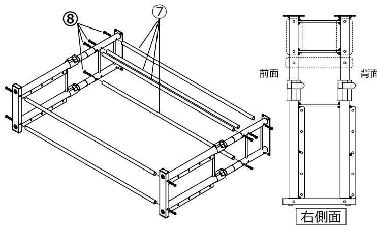
(3) ⑨ボルトで⑥補強用ポールを取り付けます。
