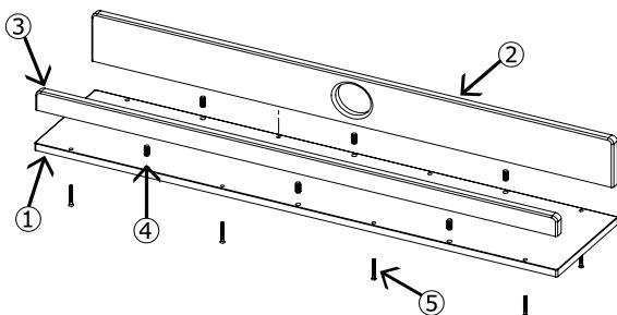
3, 底フレームに六角ボルトと六角レンチを用いて下部ポールを取り付けてください。
