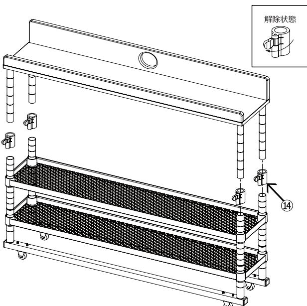
2, 高さ調節ポールを1で組み立てた天板にネジBを用いて取り付けます。
