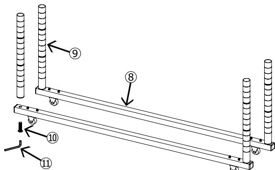
5, 4で組み立てた下部ポールにストッパーをはめ、2で組み立てた天板を取り付けてください。
