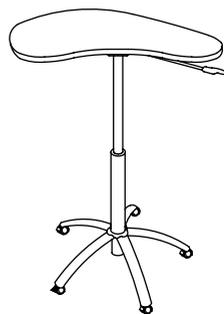
※ガスシリンダー固定ネジを締めることにより天板が安定した状態でご使用いただけます。
