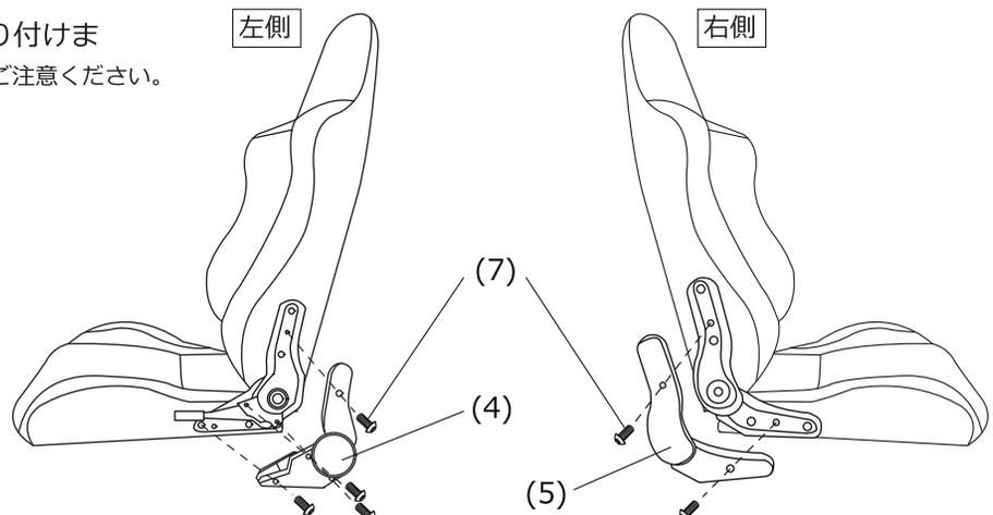
③ ①~②で組み立てたセットに肘掛部を取り付けます。
