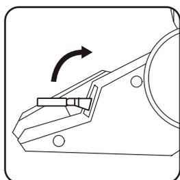
背もたれを倒す場合… 座部の左側面にあるレバーを引きながら、背もたれにもたれると背もたれが傾きます。
