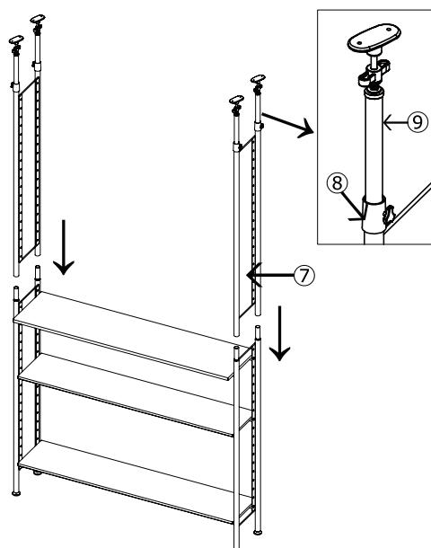
4, 上段フレームにボルト・六角レンチを用いて棚板を取り付けます。
