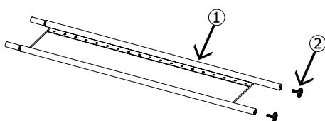
2, 下段フレームにボルト・六角レンチを用いて棚板を取り付けます。
