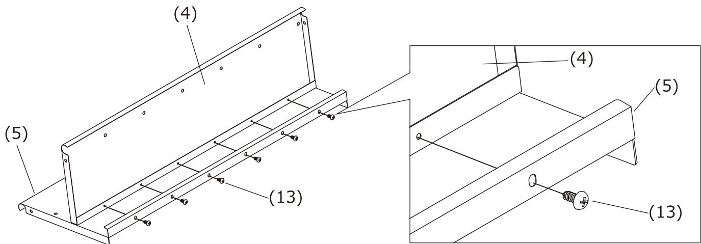
④ ③で組み立てた棚板を②で組み立てたフレームに取り付けます。
