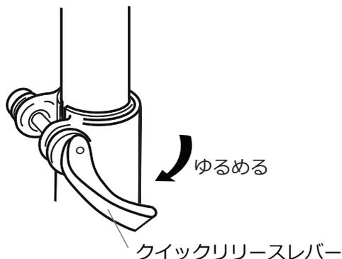
③ 両手で天板の両端をつかみ、水平を保ちながら好みの高さに調整したら、4箇所のクイックリリースレバーを右側に倒し、固定します。
