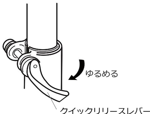
③ 両手で天板の両端をつかみ、水平を保ちながら好みの高さに調整したら、4箇所のクイックリリースレバーを右側に倒し、固定します。
