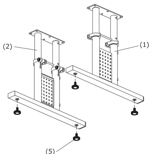
② ①で組み立てた脚部に、背部パイプを取り付けます。
