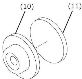
④ 全てのコの字パーツにクランプネジ、クランプ皿を取り付けます。
