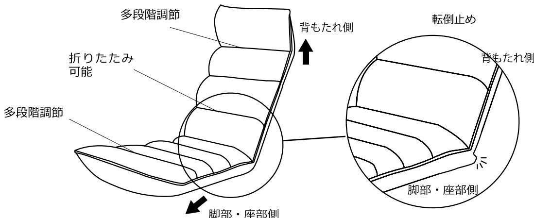
※ 製品が2つ折りになる（真ん中下・外側）あたりを指で押さえていただいくと、外側にフレームが丸く突き出ているのがわかります。これは、転倒止めで、フレームが長く伸びている側が脚部・座部側となります。座椅子の上下がわかりづらい場合の目安にもしていただけます。
