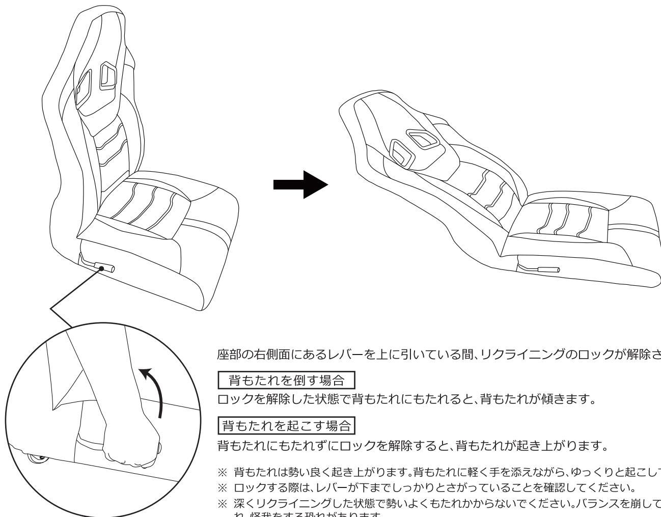
座部の右側面にあるレバーを上に引いている間、リクライニングのロックが解除されます。
