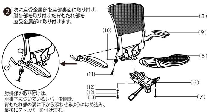
次に座受金属部を座部裏面に取り付け、肘掛部を取り付けた背もたれ部を座受金属部に取り付けます。
