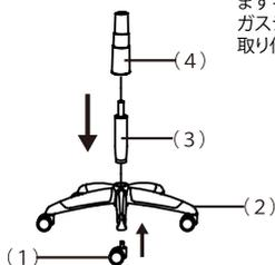
まずキャスターを脚部に差し込み、ガスシリンダーとシリンダーカバーを取り付けます。
